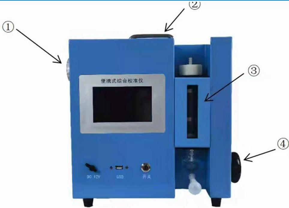
①皮膜进气口 ②把手 ③皂膜部分 ④微压泵调节把手
